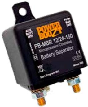
Das Funktionsprinzip ist das folgende: der PB-MBR 12/24-100 oder PB-MBR 12/24-140 lässt die Primärbatterie durch die Lichtmaschine nachladen, bis eine Spannung von 13,2V (26,4V) mindestens 7 Sekunden lang erreicht ist. Dann werden die beiden Batterien durch den Kontakt des Relais parallel geschaltet. Die Sekundärverbraucher sind normalerweise an die Hilfsbatterie angeschlossen. Das Relais öffnet sich, wenn die Batteriespannung
